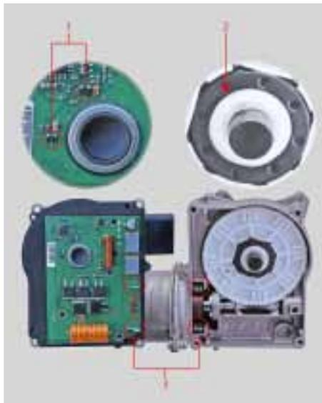
Bild 3: Innenleben eines Scheibenwischermotors von Valeo. 1 = Hall-Sensoren, 2 = Gebermagnet, 3 = Kontakte zwischen Motor und Elektronik für den Laststrom.
