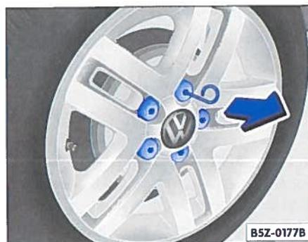
Abb. 105 Abdeckkappe mit dem Drahtbügel abziehen
