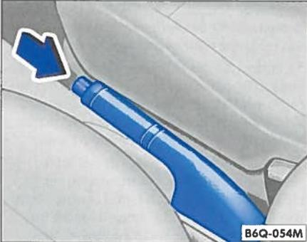
Abb. 85 Handbremse zwischen den Vordersitzen
