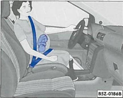
Abb. 13 Gurtbandverlauf bei schwangeren Frauen
