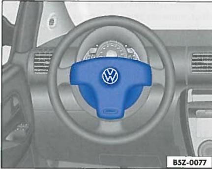
Abb. 16 Einbauort Fahrerairbag: im Lenkrad
