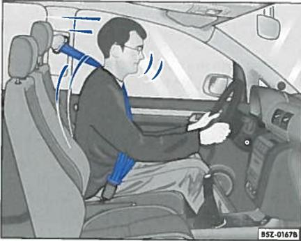
**Abb. 9** Angegurterter Fahrer, der bei einem plötzlichem Bremsmanöver vom richtig angelegten Sicherheitsgurt aufgefangen wird
