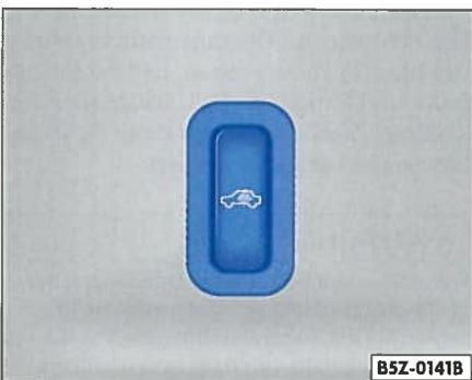
Abb. 35 Taste zum Ausschalten der Innenraumüberwachung
