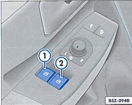
Abb. 38 Einzelheit der Armlehne der Fahrertür: Steuerungselemente der Fensterscheiben
