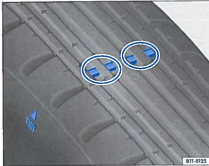
Abb. 99 Prinzipdarstellung Reifenprofil: Verschleißanzeiger
