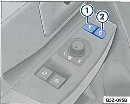
Abb. 30 Detail von der Fahrertür: Zentralverriegelungstaster
