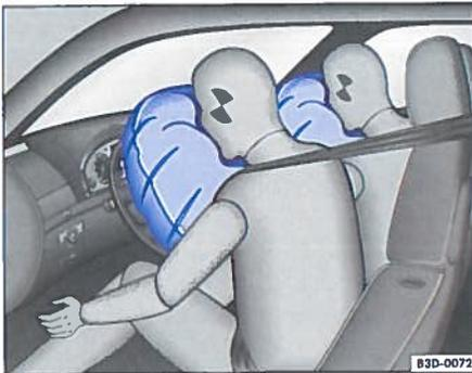
Abb. 18 Funktionsabbildung: ausgelöste Frontairbags
