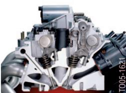
Die VALVETRONIC übernimmt in weiten Teilen die Funktion der Drosselklappe. Damit dies ermöglicht wird, ist eine vollvariable Ventilhubsteuerung nötig. Die vollvariable Ventilhubsteuerung wird durch zusätzliche Bauteile im Ventiltrieb ermöglicht. Dazugekommen sind in erster Linie Stellmotor, Exzenterwelle, Zwischenhebel und Drehfeder.
