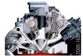
Die VALVETRONIC übernimmt in weiten Teilen die Funktion der Drosselklappe. Damit dies ermöglicht wird, ist eine vollvariable Ventilhubsteuerung nötig. Die vollvariable Ventilhubsteuerung wird durch zusätzliche Bauteile im Ventiltrieb ermöglicht. Dazugekommen sind in erster Linie Stellmotor, Exzenterwelle, Zwischenhebel und Drehfeder.
