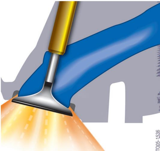
7 - Einströmung am Ventilspalt
