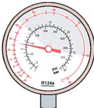
Niederdruck normal (●) oder zu niedrig (▲) Hochdruck zu niedrig oder zu hoch (▲)
