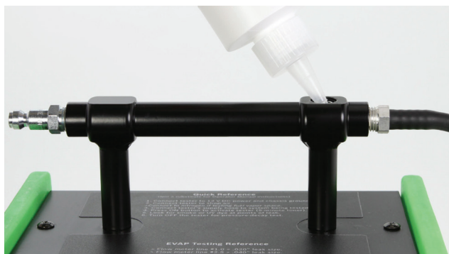
Abb. 5: Einfüllen der UltraTraceUV® Rauchlösung
