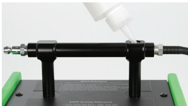
Fig. 5: Riempimento con soluzione fumo UltraTraceUV®
