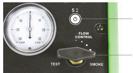
Fig. 9: Regulador de caudal de fumo completamente aberto
