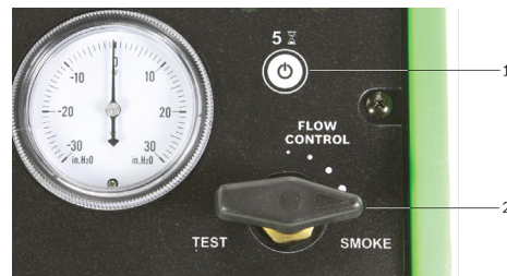
Abb. 9: Rauchstromregler vollständig geöffnet
