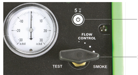
Rys. 9: Regulator strumienia dymu całkowicie otwarty
