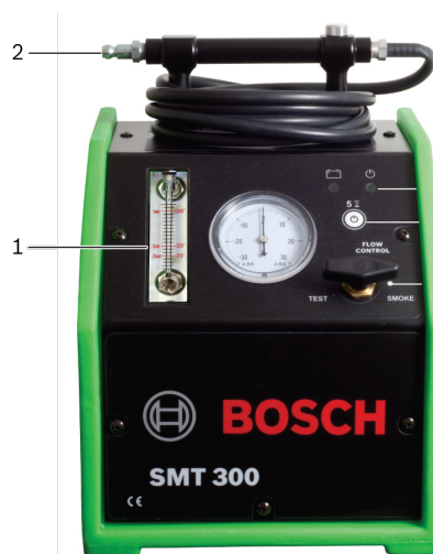
Rys. 8: Badanie EVAP przy użyciu SMT 3000
