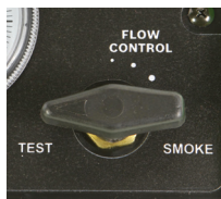
Kuva 2: Savuvirtasäädin säädössä "TEST"
