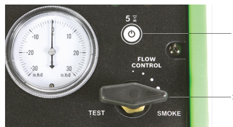
Fig. 9: Røgstrømsregulator fuldstændigt åben
