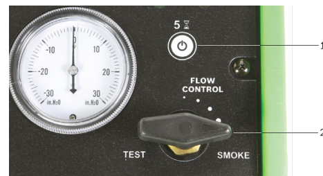
Fig. 9: Røykstrømregulator fullstendig åpen
