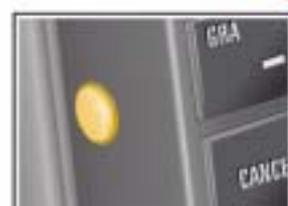
Seitlich hinten am Tastenmodul befindet sich ein zusätzlicher Taster zum Abschalten der Tastenbeleuchtung.
