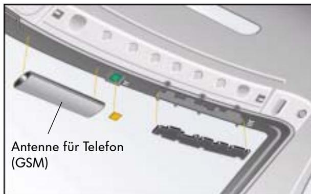
Antenne für Telefon (GSM)
