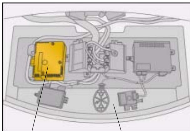
Steuergerät für Telefon/Telematik
