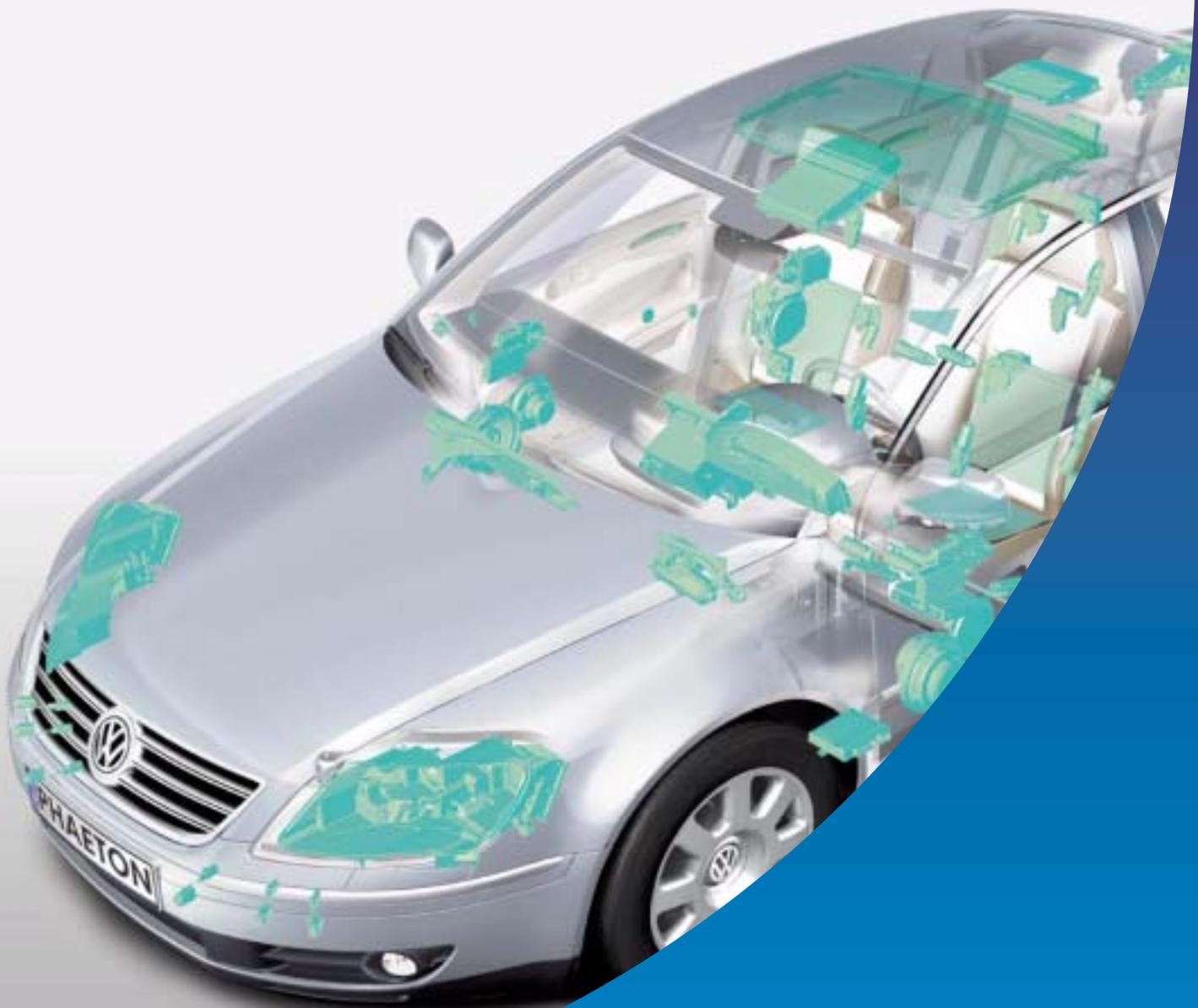
Sesam öffne dich - durch ein neues System für Zugang und Startberechtigung erfolgt der Zutritt zum Phaeton ohne aktive Schlüsselbenutzung (1). Über eine Antenne im Türaußengriff (2) wird der Wunsch zur Öffnung erkannt und über ein Steuergerät (3) die Berechtigung identifiziert. Die Entriegelung des Phaeton erfolgt über das Zentralsteuergerät für Komfortsystem (4) und das Türsteuergerät (5).
