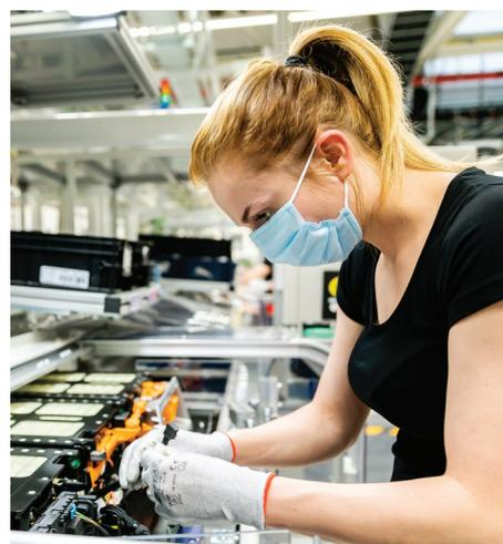
Immer noch viel Handarbeit und nur Teilautomatisierung: Die Batteriezellen werden zu Modulen zusammengefügt. Um konkurrenzfähig zu sein, wird oft in Niedriglohnländern produziert. Quelle: Mercedes-Benz
